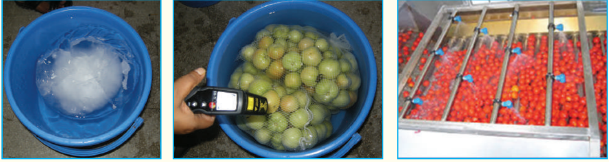
চিত্র-৩৬: সাধারণ নকডাউন হাইড্রোকুলার (সর্ববামে ও মাঝে) এবং ওভারহেড হাইড্রোকুলার (সর্বডানে)
